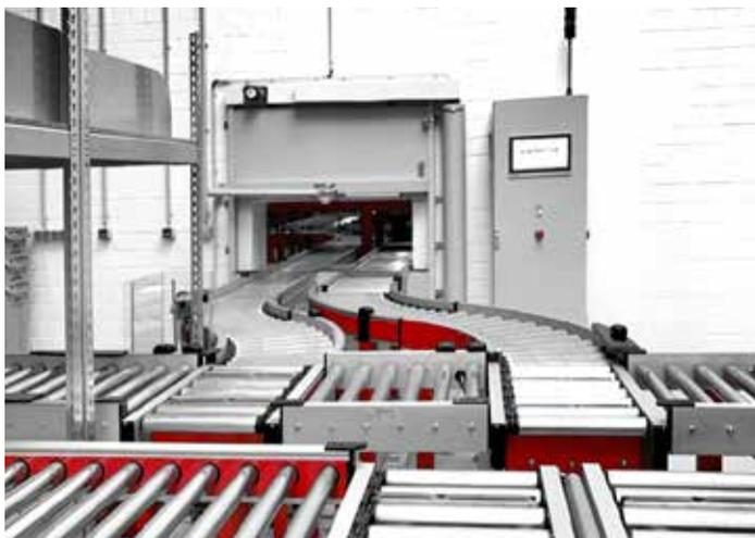
El sistema **HUBMASTER®** incluye las cabeceras del sistema para la **extracción de cargas del almacén en modo automático**, mediante transportadores de rodillos o banda, según el caso.
